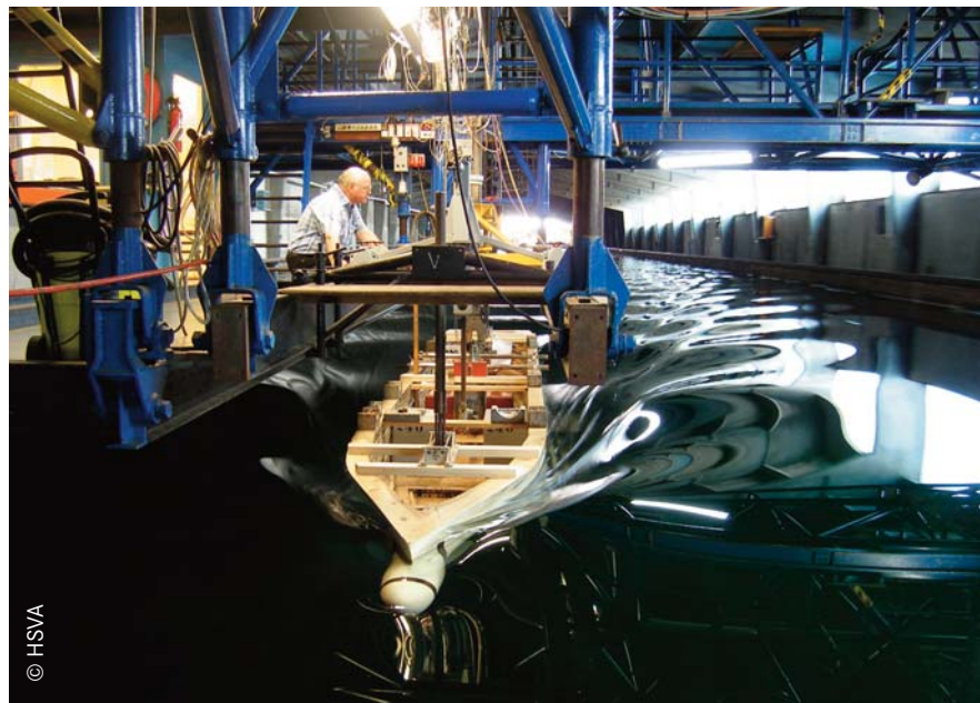
Wie gut Wulstbug und Schiffsrumpf in ruhigem Wasser zusammen passen, wird hier genau gemessen.
